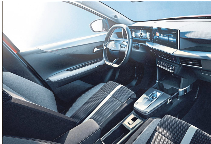
Die mittig in den Sitzen verlaufene Vertiefung soll den Druck auf das Steißbein verringern.
